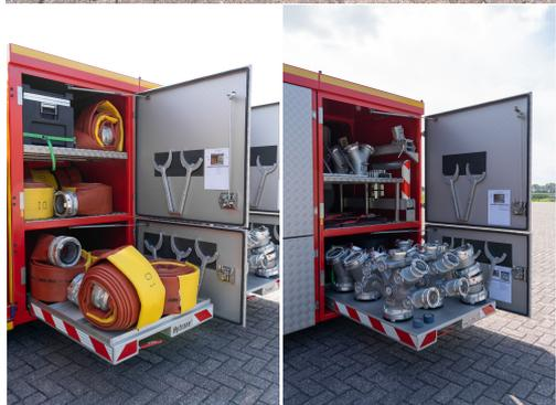
de matériaux légers tels que des planchers et des panneaux de toit en aluminium, le CombiContainer est facile à manipuler. Les HoseBlocs brevetés dans le compartiment du tuyau empêchent le tuyau de se déplacer pendant la manutention du conteneur.
